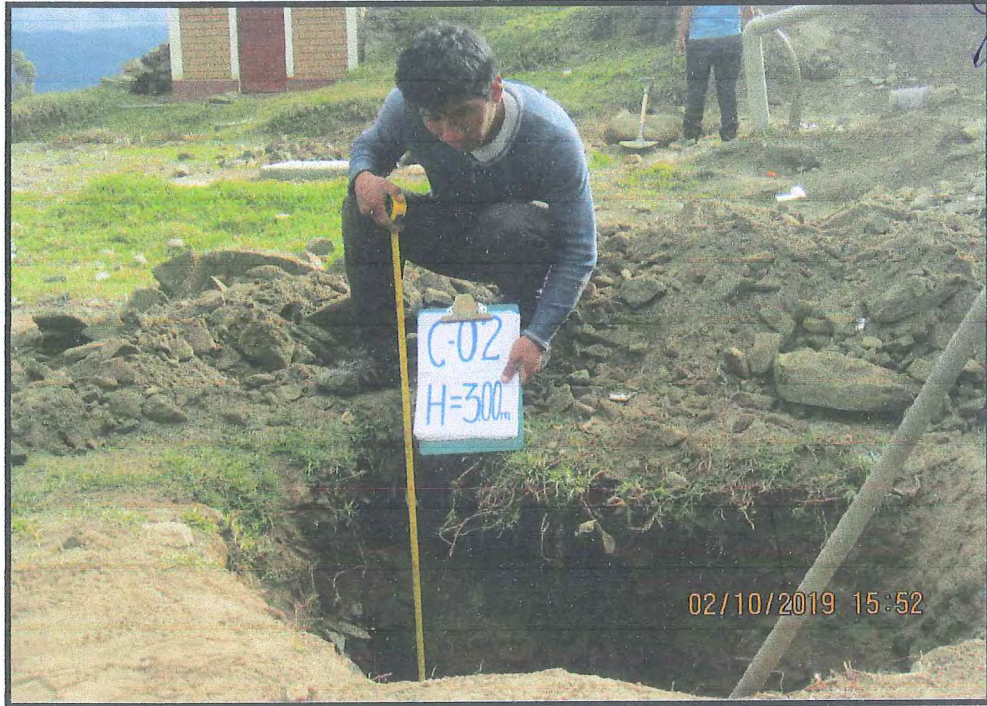
Vista N° 6. Excavación de calicata 02 altura 3.00 ml.
